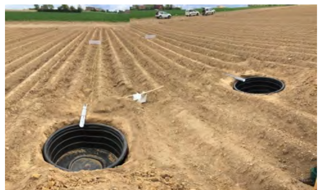
Dispositif de récolte d'eau et de terre issu du ruissellement
